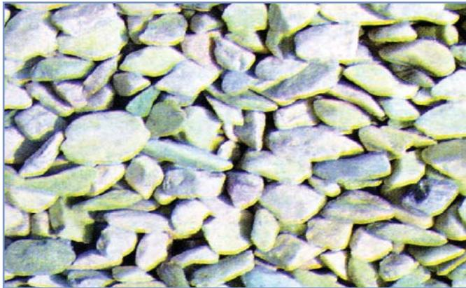
**Figura 5** - Sovracopertura in granulato lapideo calcareo ammonitici (Verdello).
